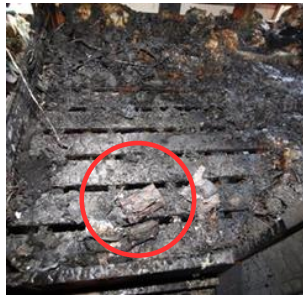
内蔵されたリチウムイオン電池がショートした事例
